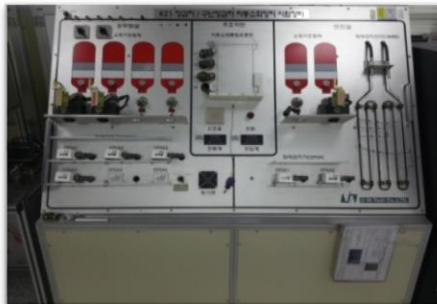
자동소화장치 시스템 종합시험장비 (K21/신형화생방정찰차량/K2전차/장애물 개척전차/차륜형장갑차/지휘소장갑차)
