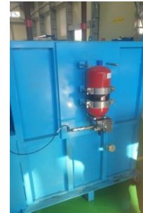
소화기 안전점검 장비 (낙하, 분사시험)
