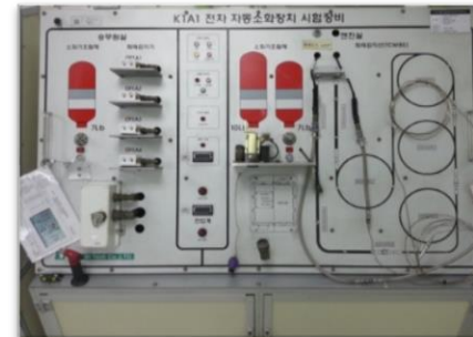
자동소화장치 시스템 종합시험장비 (K21/신형화생방정찰차량/K2전차/장애물 개척전차/차륜형장갑차/지휘소장갑차)
