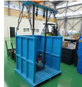
소화기 안전점검 장비 (낙하, 분사시험)
