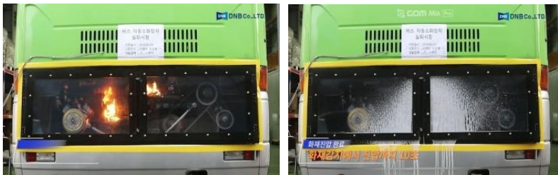
실차 화재진압 테스트 완료 (10초 이내 감지 및 진압 완료)
